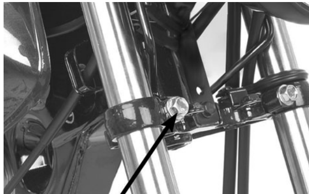
PARAFUSO DE FIXAÇÃO INFERIOR EMBLEMA DIANTEIRO
