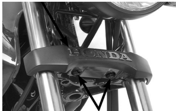
PARAFUSOS PARAFUSO DA MESA SUPERIOR
