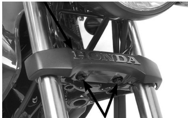
PARAFUSOS SUPORTE DO FAROL/PAINEL DE INSTRUMENTOS
