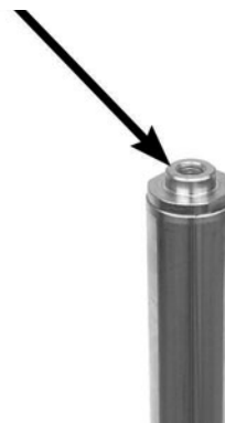
ARRUELA PARAFUSO DE FIXAÇÃO PARAFUSO SUPERIOR DO GARFO
