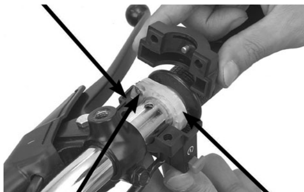
CABO DO ACELERADOR TUBO DO ACELERADOR
