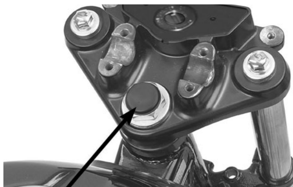
COBERTURA DA COLUNA DE DIREÇÃO SUPORTE DO FAROL/PAINEL DE INSTRUMENTOS
