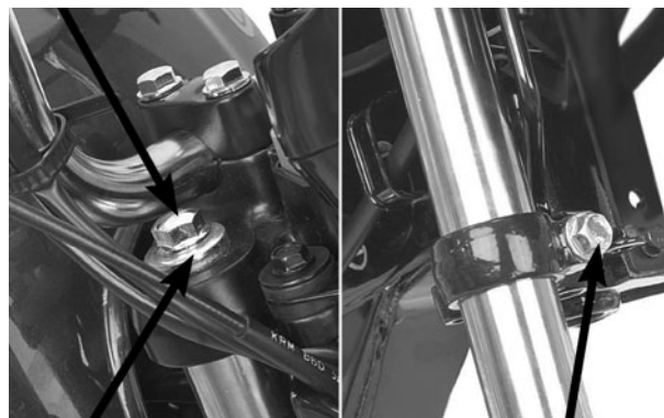
ARRUELA PARAFUSO DE FIXAÇÃO PARAFUSO SUPERIOR DO GARFO
