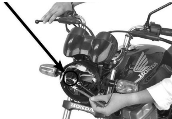
CONECTORES DA FIAÇÃO DO INTERRUPTOR DA LUZ DO FREIO DIANTEIRO
